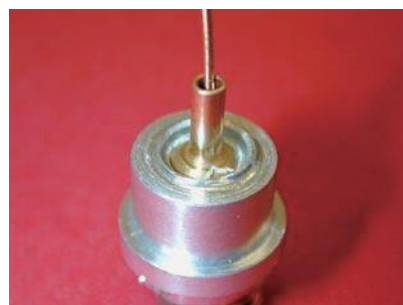
图 1.c 在中轴线和连接销之间的宽隙可以通过焊料桥接，体现了微焰焊接的优势。没有其他加热技术可以完成这个任务。
