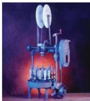
B9 Maypole 系列编织机 8、 12、16 锭可选，编织直径 2 毫米 编织材料纺织品和塑料纱
