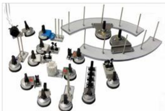
导线支架安装在吸盘
