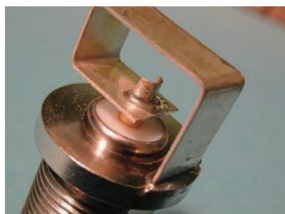
图 1.g 微波连接器里的阻抗桥被焊在中间销和外壳上。90 度的弯曲的火焰喷嘴可以很容易接近中间销焊接。
