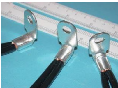
图 . j 无铅焊接密封不仅解决了腐蚀问题与此同时也使拉拔强度增加到 300% 公差也被减少到很小。
