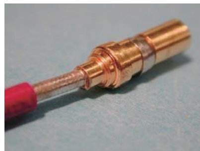
图 1.f 同轴电缆护罩巧妙地焊接到连接器接地护套里。
