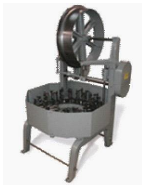
CB1 Maypole 系列编织机 16~64 锭 编织高压强化大直径软管 最大编织直径：38.1 毫米
